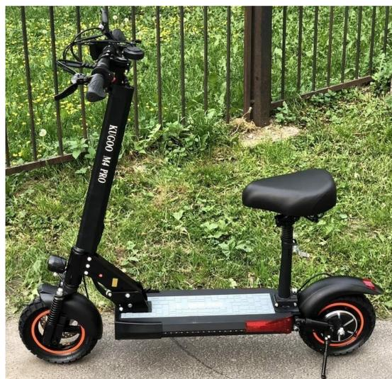
Самокат оснащен сидением, которое обеспечивает комфортную езду в длительных поездках, что немаловажно для самоорганизованных речных сплавов. У самоката складывается сиденье и ручки, в итоге устройство практически в два раза уменьшается и легко складывается всего за несколько секунд. Его можно положить в багажник обычного легкового автомобиля. Если
